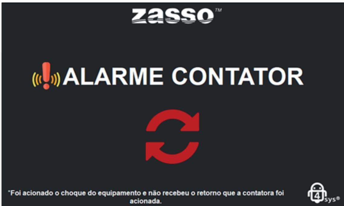
Fig. 32- Alarme contator
