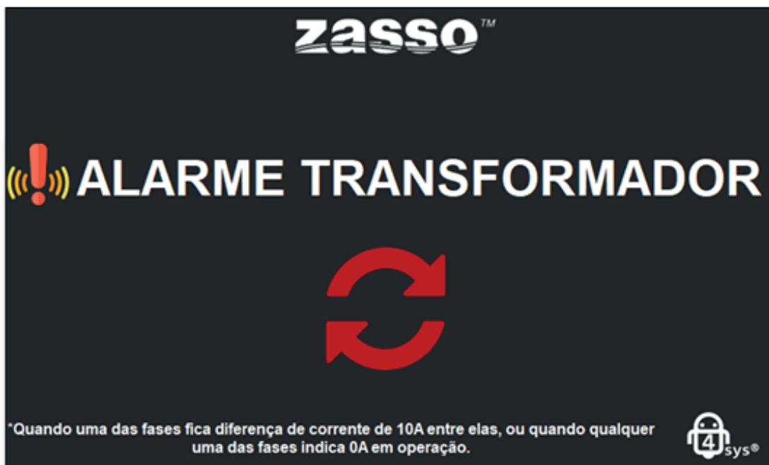
Fig. 34- Alarme transformador
